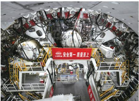
昨日，在济南市黄岗路穿黄隧道，“山河号”盾构机在掘进作业。当日，山东省济南市黄岗路穿黄隧道顺利完成黄河段掘进任务，这一世界最大直径水下盾构隧道工程建设取得阶段性突破。济南市黄岗路穿黄隧道全长约5755米，其中盾构段长约3290米，盾构机开挖直径17.5米，是目前在建的世界最大直径水下盾构隧道。
